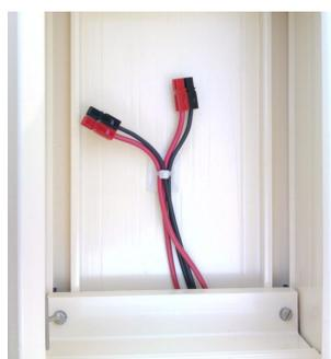
Dans le fond de l'armoire, au niveau des logements batteries se trouvent deux paires de connecteurs rouge/noir.
